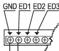
Ligação elétrica para operação automática do comando 1 utilizando uma bóia comum
