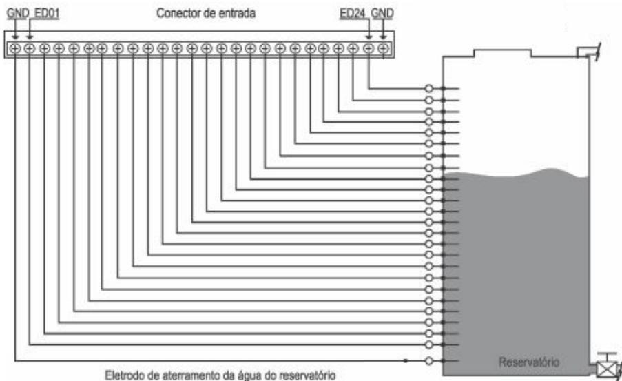
Na figura, podemos notar que, neste momento, a água cobre 16 eletrodos. No canto superior direito da Interface será, então, exibido o n.º 16. Ainda na figura, pode-se notar que os eletrodos estão ligados às entradas em ordem, ou seja, nota-se que o eletrodo 1 está ligado à entrada ED1, o eletrodo 2 está ligado na entrada ED2, e assim por diante. Esta ordem, no entanto, não precisa ser obedecida. Pode-se
