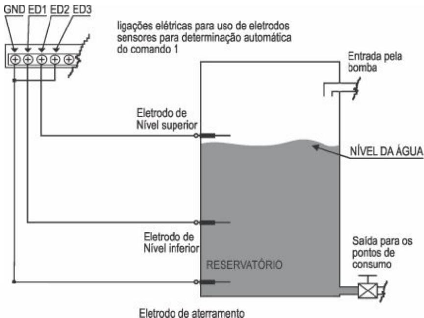
Quando se pretende fazer uso do timer 1 para desligamento no horário de pico de consumo, um novo eletrodo de Nível Mínimo de Segurança deve ser instalado
