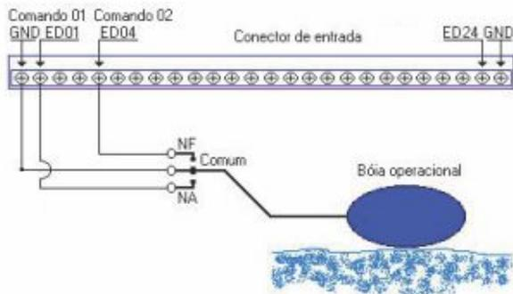
Na figura, podemos notar que se utilizaram os três terminais da bóia. Quando o nível de água do reservatório que suporta a bóia diminuir, seus contatos “Comum” e “NA” serão fechados. Isso fará com que a entrada ED01 seja conectada ao terra (GND) e o comando 1 será ativado. Após acontecer a transmissão do pacote, no receptor será ativado o comando A (fecharão os contatos dos reles 01 e 02).
