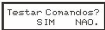
Pressione a tecla "SIM". Pronto! Neste modo de operação, cada rele passa a ser controlado exclusivamente por sua tecla de operação manual correspondente. Observe que na linha superior do display ficará, constantemente, sendo exibida a seguinte mensagem: "Pressione a tecla correspondente a cada saída abaixo". O transmissor nada interferirá neste modo de operação.
