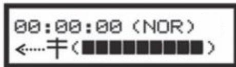
No canto superior esquerdo podemos notar a presença de um relógio digital. Este relógio marca tempo real de 24 horas por dia. Toda vez que é energizado, desde que não esteja energizado por um nobreak ou sistema de geração solar, o relógio é zerado, isto é, passa há marcar zero horas, ou, popularmente, meia noite. Informações de como proceder ao ajuste do relógio serão apresentadas oportunamente neste manual, adiante.
