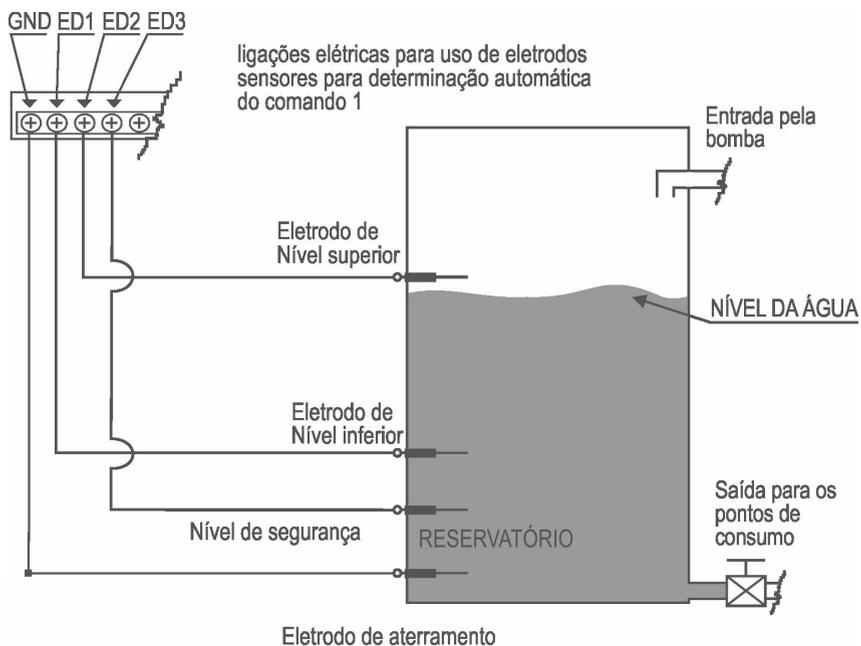
O mesmo procedimento de ligações elétricas deve ser observado quando do uso de sensores de nível para determinação dos demais comandos (do comando 2 ao 8).
