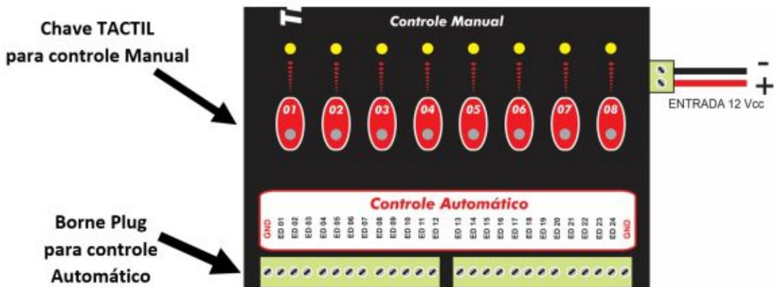
Os comandos podem ser gerados de forma automática quando o usuário queira que os equipamentos controlados no lado receptor sejam ligados ou desligados pela ordem de uma bóia de nível, por um sensor de eletrodos de contatos com a água ou por outro dispositivo qualquer.
