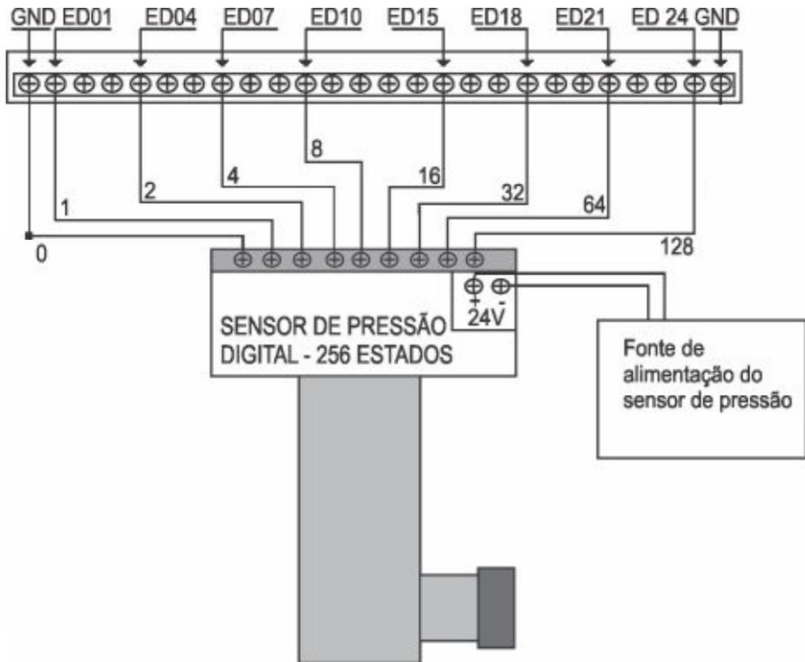
Obs.: Na figura, temos um sensor de pressão digital de 256 degraus. No entanto, é possível a utilização de sensores de pressão analógicos (transmissores de pressão) com saídas de 4 a 20ma. Os sensores analógicos necessitam serem ligados à conversores analógicos/digitais de 1 byte, de tal forma que o intervalo de variação de corrente de 4 a 20 ma possa ser representado por um número digital de 256 degraus. Este número é o próprio comando aceito pela Interface.
